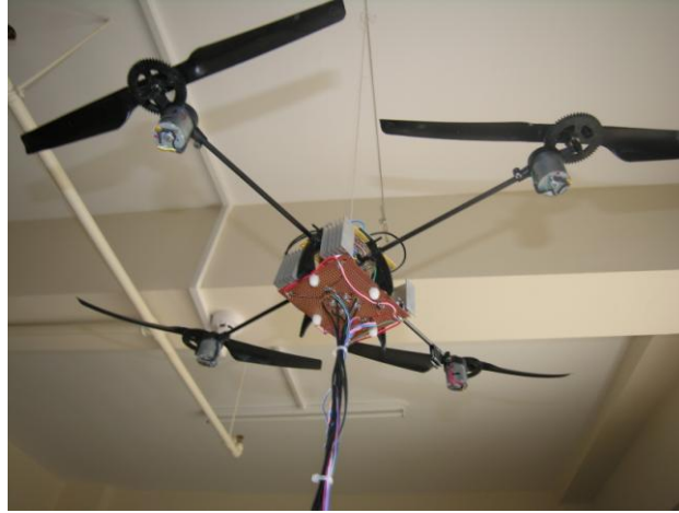
Şekil 23 Algılayıcı Kümesi Genişletilmiş, Bilgisayar Denetimli, Dört Pervaneli Uçar Platform (Atılım Üniversitesi)
