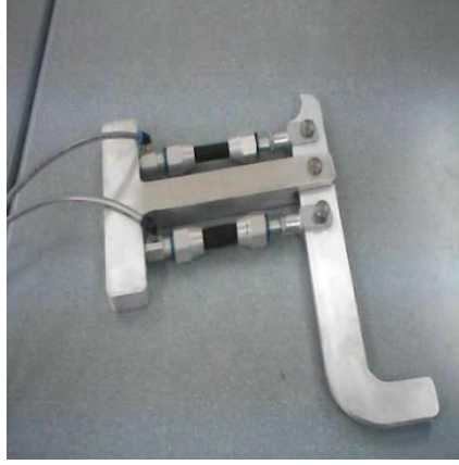
Şekil 14 Yapay Kaslarla Tahrik Edilen Bacak Mekanizması (Atılım Üniversitesi)
