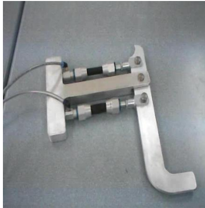
Şekil 5. Festo yapay kasları ile geliştirilmiş böcek benzeri bacak mekanizması (Atılım Üniversitesi, Biyobenzetimle Tasarım Laboratuvarı)
