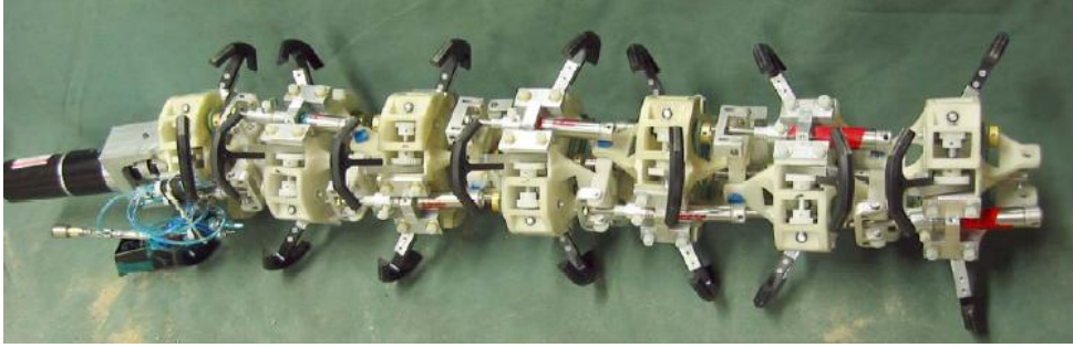
Şekil 1. OmniPede yılan robot [4]
